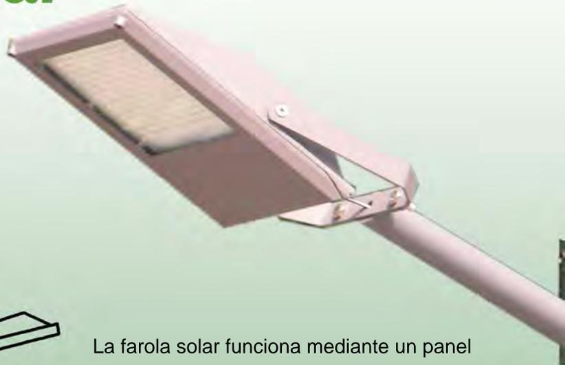
La farola solar funciona mediante un panel fotovoltaico que carga la batería, la cual suministra energía a la lámpara. Cuando la luz disminuye se activa la iluminación de las lámparas, las cuales se apagarán cuando el sensor detecte de nuevo luminosidad. No obstante, puede disminuirse
